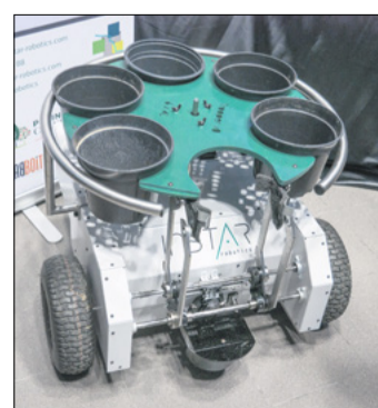
Der Trooper transportiert autonom Pflanzentöpfe.
