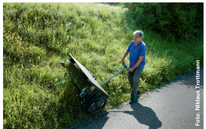
Mit der Wiesen-Saatguterntemaschine «eBeetle» erntet Daniel Kuster die Samen von reifen Heuwiesen.
