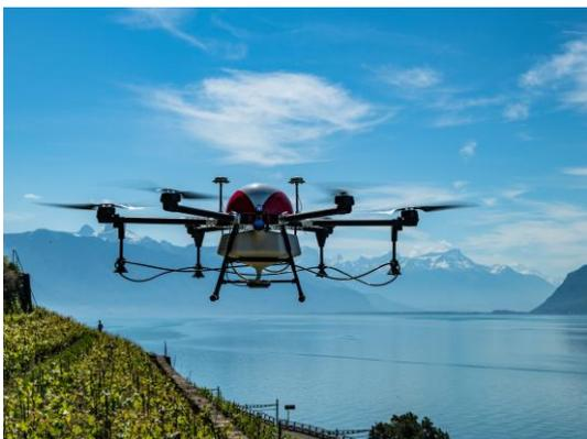
PFLOPF-Massnahme 7: Drohnen zur Pflanzenschutzausbringung vereinfachen in Steillagen die Applikation zum optimalen Behandlungszeitpunkt bei gleichzeitig reduzierter Abdrift. Bildquelle: Agrofly
