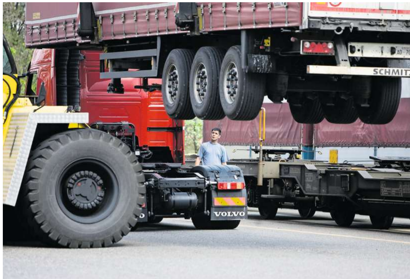
Mit einem Kran werden am Hupac-Terminal in Aarau Lastwagen auf die Schiene verladen.
